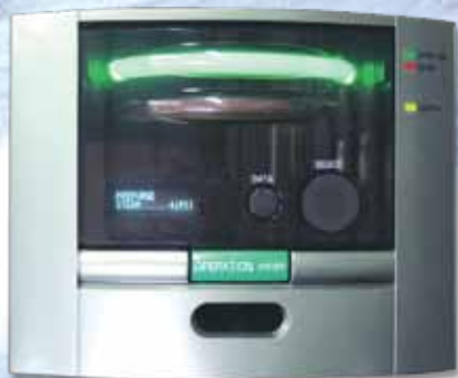
Système de contrôle de la chaudière par microcontrôleur BL
